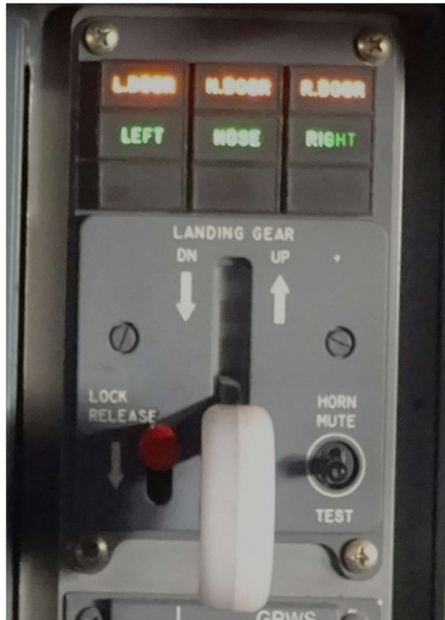
«LGCIP» - Panel de Indicación y Control de Trenes de Aterrizaje
